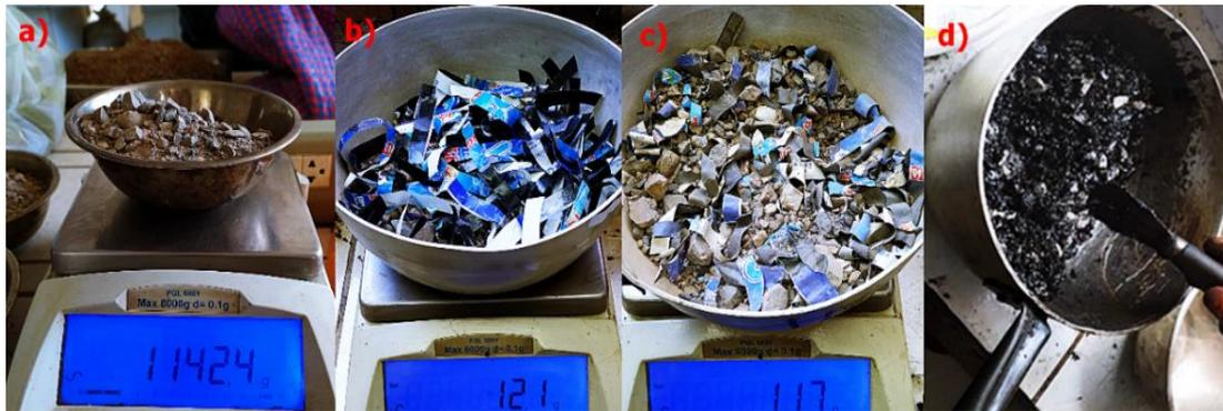
Figura 2. Resumen de la elaboración de los cuerpos de prueba para la mezcla asfáltica convencional incorporada con polietileno de baja densidad.
